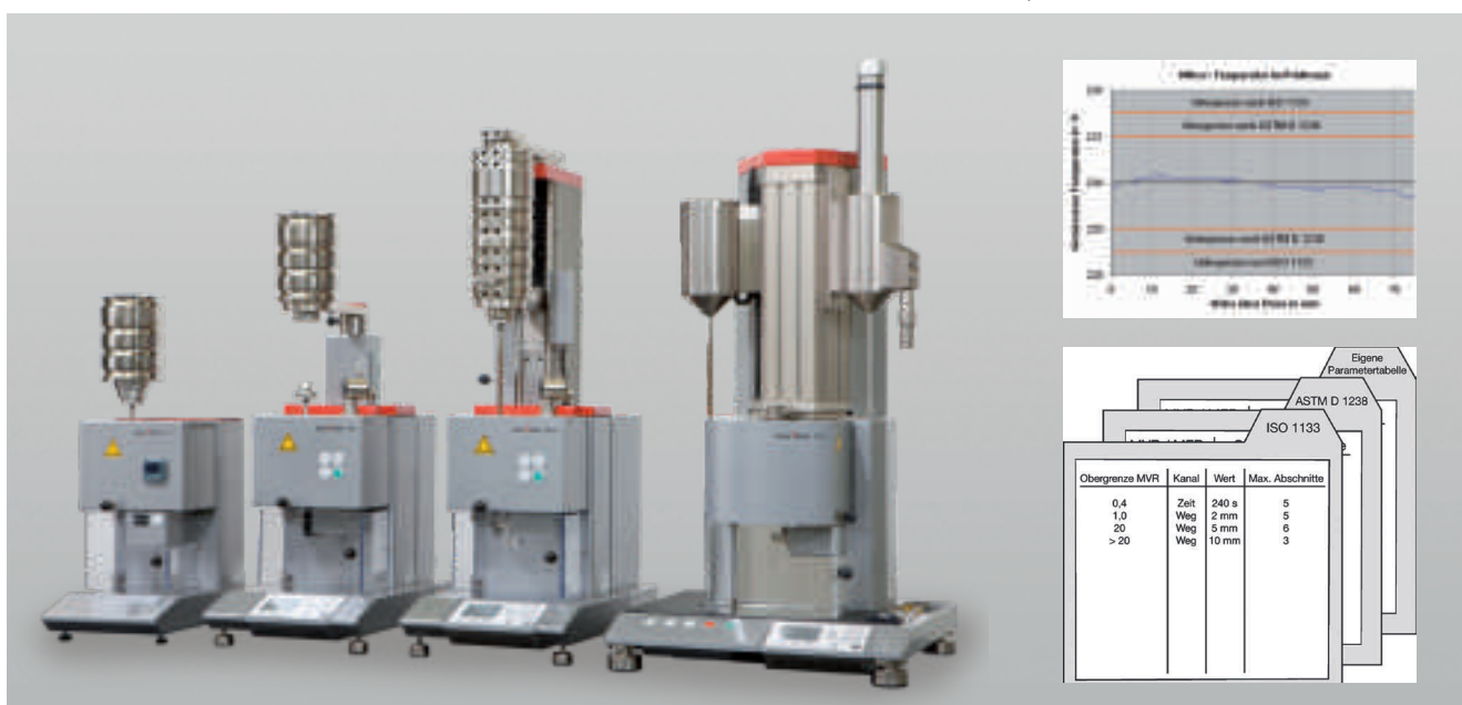
Рис. 1: пластометры серии X'ow: точное управление температурой с подготовкой к испытаниям РА, РВТ и РЕТ (сверху справа). Автоматическое управление характеристикой (APC): каждое испытание проводится с первого раза с оптимальными параметрами (справа внизу).
