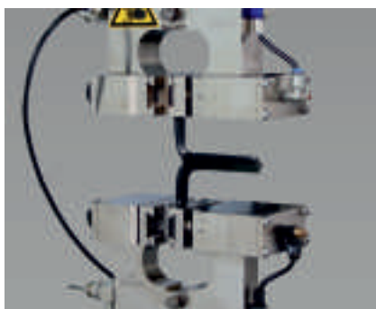
Рис. 2: разрыв образца "в форме брюк" по ISO 34-1
