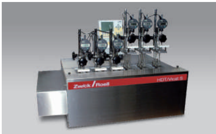
Рис. 3: прибор HDT/Вика 6-300 S обладает электромагнитным клапаном для управления охлаждением. Этот прибор может иметь от 1 до 6 измерительных станций.
