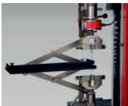
Рис. 3: испытание на разделение под углом 180°: упор поддерживает угол разделения постоянным.
