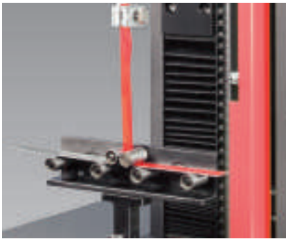
Рис. 1: отрыв под углом 90° для измерения сопротивления отслаиванию
