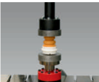
Рис. 4: динамическое испытание звукоизоляционных плит и демпферов
