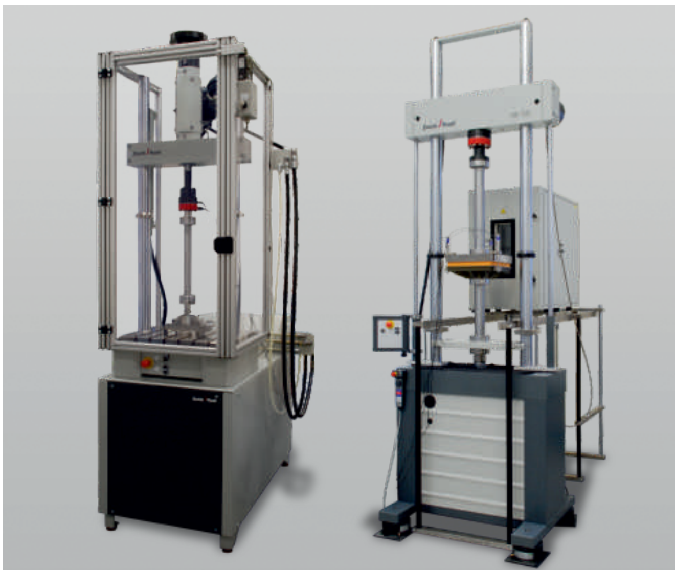
Рис. 1: сервогидравлические испытательные машины для быстрого циклического нагружения
