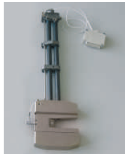
Рис. 5: для испытаний по Шарпи молот маятника инструментирован.
