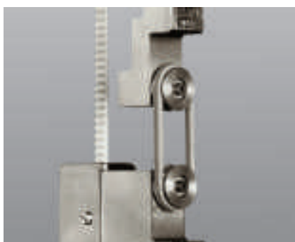
Рис. 4: испытание колец на растяжение по ISO 37
