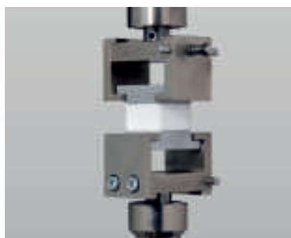
Рис. 4: растяжение с вертикальным приложением усилия по EN 1607
