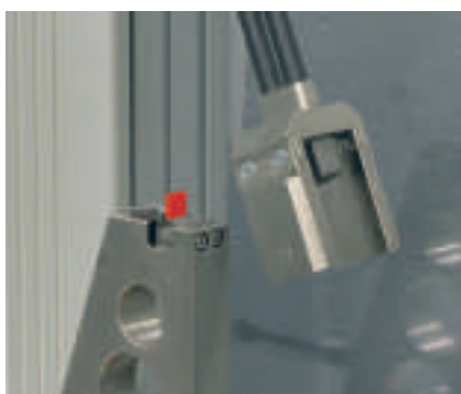
Рис. 4: механизм для испытаний Dynstat на ударный изгиб
