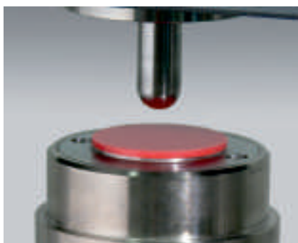
Рис. 4: испытание на пробой по ISO 6603-2 с регистрацией усилия/перемещения
