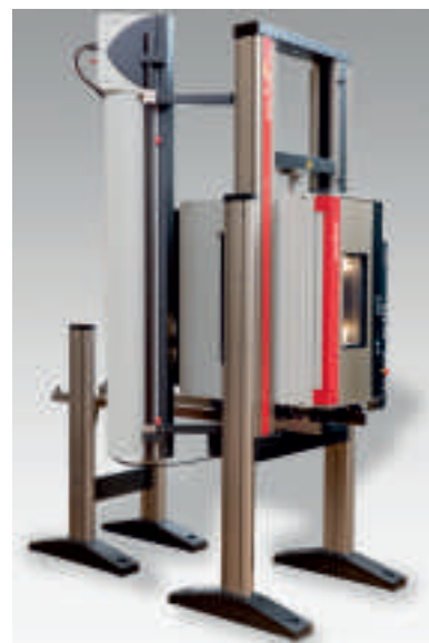
Рис. 2: термокамеру можно выводить из рабочей зоны по шинам
