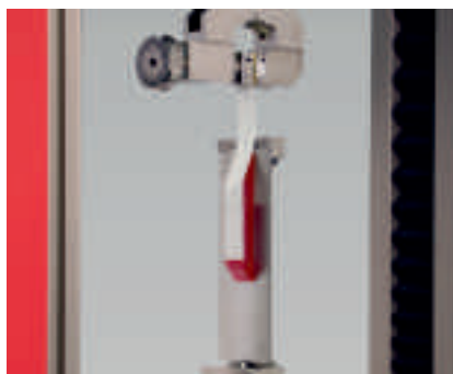
Рис. 6: отрыв под углом 180° по EN 1939 и AFERA 4001
