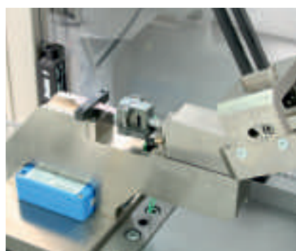
Рис. 3: инструментирование конструкции для испытаний на ударное растяжение на кронштейне.
