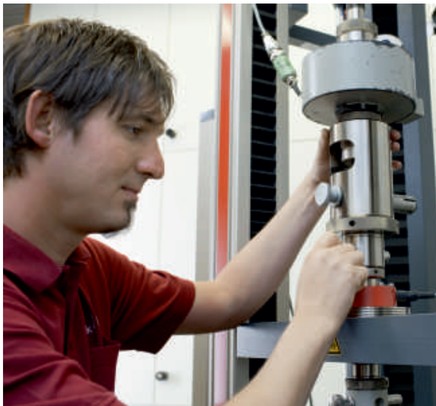
Рис. 2: каждый датчик силы проходит заводскую калибровку фирмы Zwick сразу после установки на испытательную машину.
