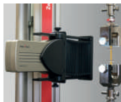
Рис. 5: videoXtens HP для оптического измерения продольной и поперечной деформации
