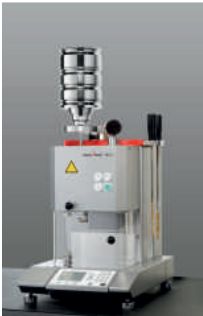
Рис. 1: модульный пластометр M'ow. Слева - с механизмом перемещения грузов, справа - с дополнительным механизмом выбора груза
