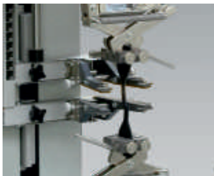
Рис. 1: испытание на растяжение по ISO 37
