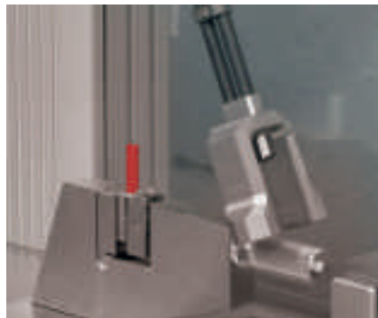
Рис. 1: традиционные ударные испытания: слева по Шарпи, справа по Изод
