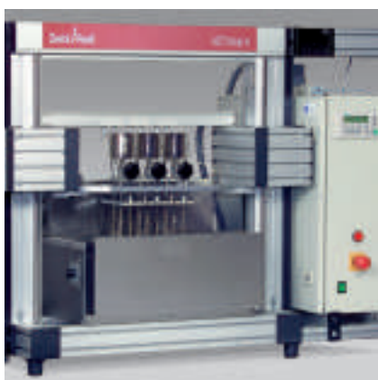
Рис. 1: прибор HDT/Вика 3- или 6-300 А располагает встроенным теплообменником, размер ванны подходит для трех или шести измерительных станций.
