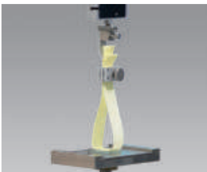
Рис. 4: определение начального сцепления наклеек в процессе испытания Loop Task по методу Finat FTM 9
