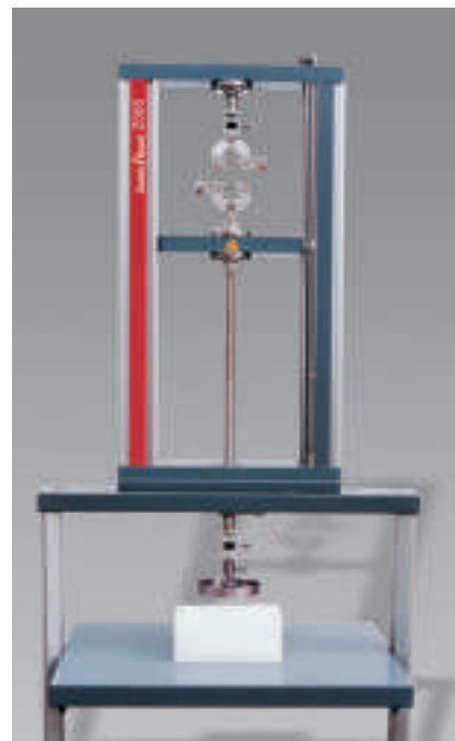
Рис. 2: испытание изделия из пенного материала в третьей рабочей зоне под нагружающей рамой
