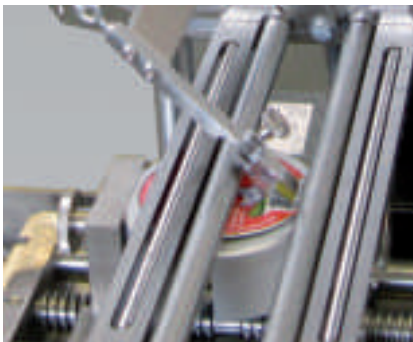
Рис. 2: испытание сварного шва на стаканчике для йогурта. Угол отрыва остается постоянным.
