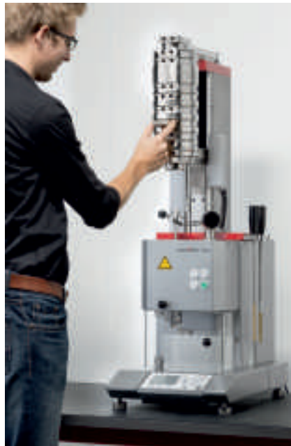
Рис. 1: модульный пластометр M'ow. Слева - с механизмом перемещения грузов, справа - с дополнительным механизмом выбора груза
