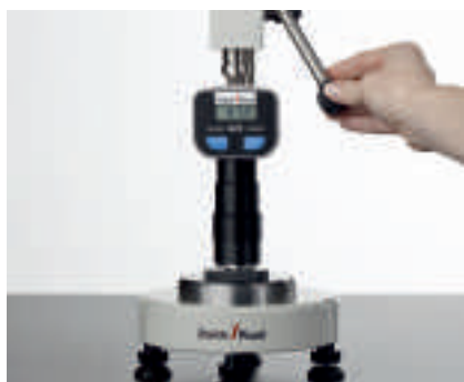
Рис. 2: измерение твердости по Шор А, ISO 7619-1
