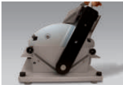
Рис. 1: с помощью прибора для нарезания полосок можно одновременно вырезать до 10 образцов (в зависимости от их ширины). Кромки прямые, параллельные и ровные.
