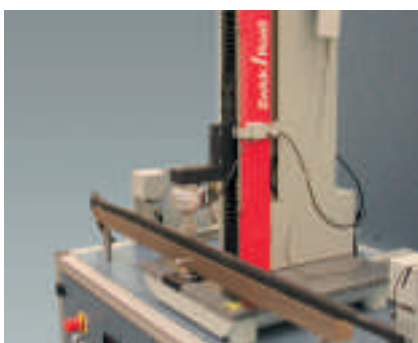
Рис. 2: измерение усилия ввода стекла бокового окна в уплотнительный профиль
