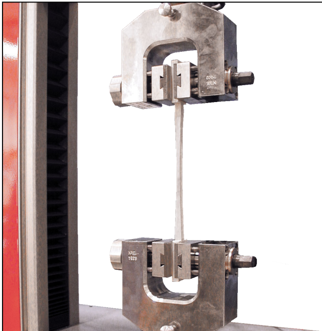
Schraub-Probenhalter Typ 8354 (318587), Fmax 10 kN
