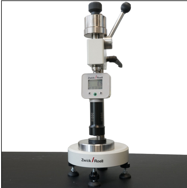
Digitales ZwickRoell 3130 Härteprüfgerät nach Shore
